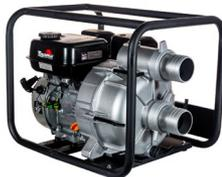
La bomba de basura autocebante Toyota TOTWP80T-XP, fue desarrollada para uso profesional. Está equipado con un motor de gasolina de máxima potencia de 7 hp con arranque manual. Fabricado con materiales de alta resistencia y durabilidad, tiene un cuerpo de aluminio con un diámetro de succión de 3" y un diámetro de descarga de 3". El rotor y la voluta están fabricados en hierro fundido. Dispone de un marco tubular que protege el conjunto y facilita el transporte.
